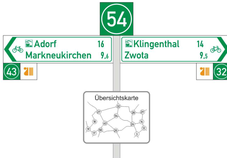
Abbildung 6.2 Ergänzung der Zielwegweiser durch Knotenpunktnummern (Weiß auf grünem Grund): Knotenpunktnummer des Standortes über den Wegweisern, benachbarte Knotenpunktnummern als Einschub
